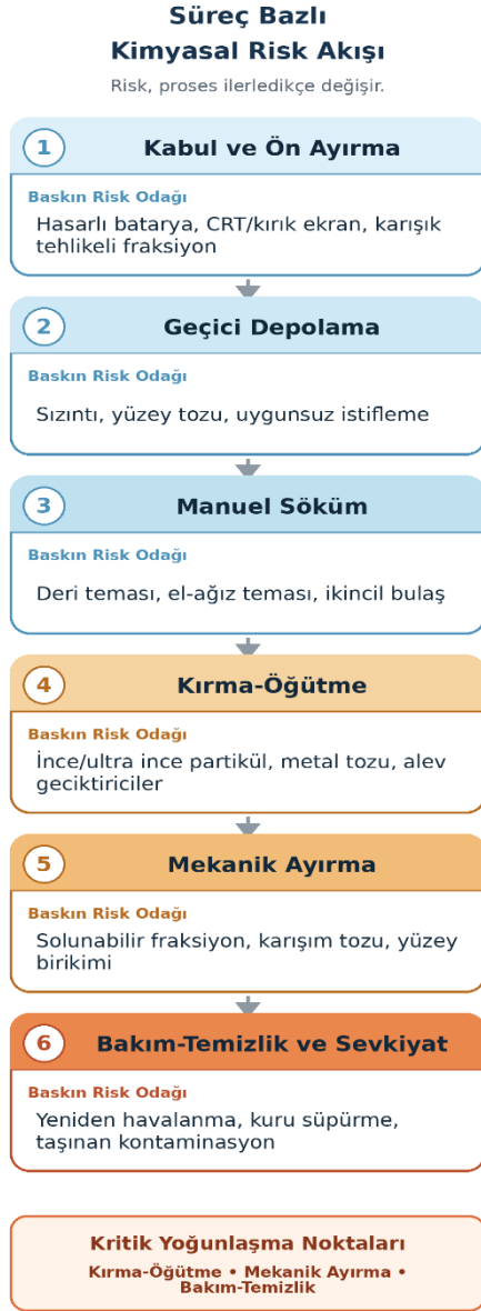
Şekil 2. Elektronik Atık Geri Dönüşüm Sürecinde Kimyasal Riskin Yoğunlaştığı Aşamalar
